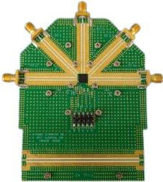
图2.5 QFN 5x5封装四通道开关评测板
